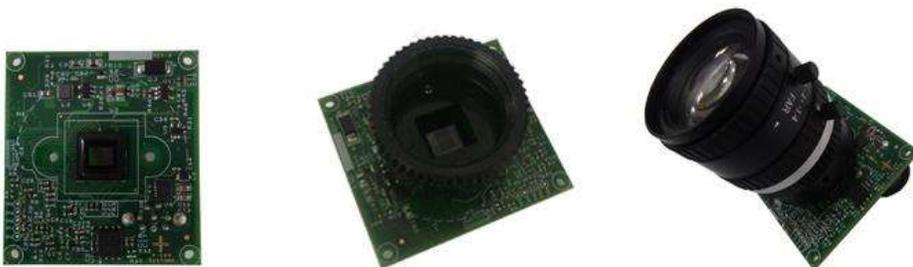
**Abbildung: 1 – See3CAM\_10CUG – 1MP handelsübliches Objektiv USB 3.0-Kamera**
