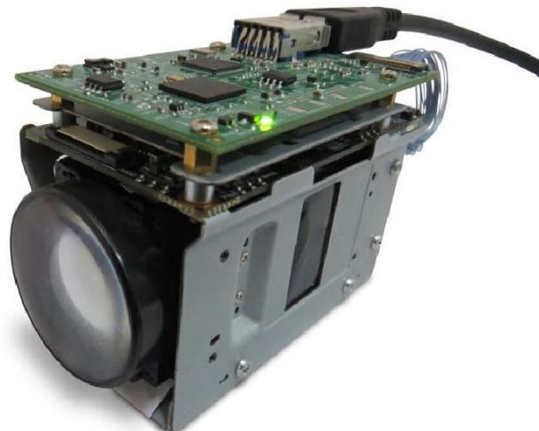
**Abb. 1: See3CAM\_30Z10X – 3MP USB3 10-fach optische Zoom-Kamera**
