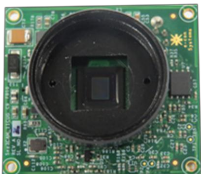
Abbildung 1: See3CAM_11CUG - 1,3 MP-Kamera mit CS-Mount-Objektivhalter
