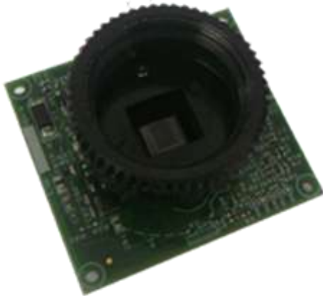
Abbildung 1: See3CAM_10CUG - Global Shutter-Kamera (1 Megapixel) mit mit CS-Mount-Objektivhalterung
