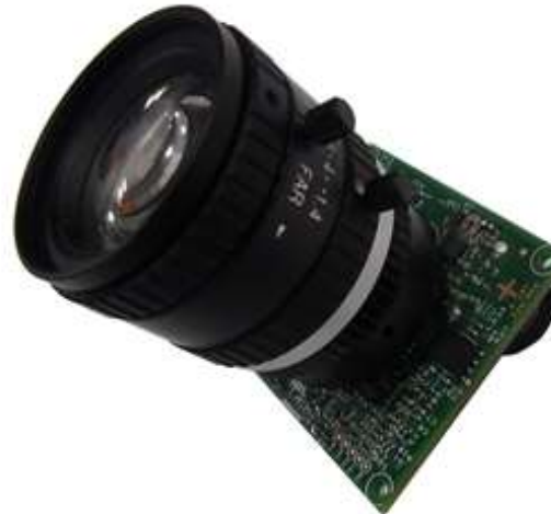
Abbildung 2: See3CAM_10CUG - Global Shutter-Kamera (1 Megapixel) mit mit CS-Mount-Objektivhalterung & Objektiv
