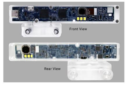
Fig :1 Tania – Cypress<sup>®</sup> CX3<sup>™</sup> Socionext<sup>®</sup> ISP RDK with Dual Sony<sup>®</sup> Sensors
